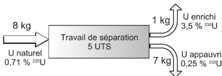
Figure 11.4 – Ordres de grandeur pour l'enrichissement de l'uranium.
